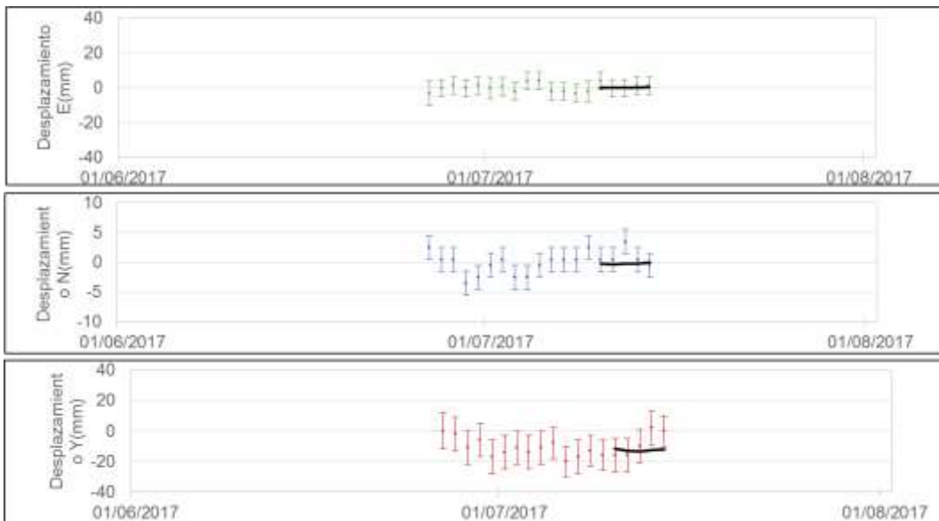
Figura 91. Variaciones en las direcciones Norte, Este y altura de la estación GNSS Laguna instalado en el volcán Azufral, para el periodo comprendido entre el 26 de junio de 2017 y el 15 de julio de 2017.
