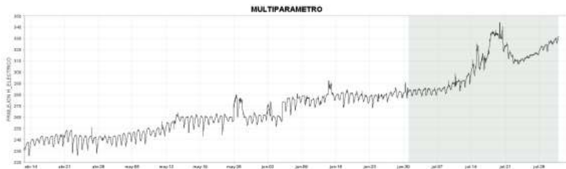
Figura 31. Variaciones de la componente horizontal del campo eléctrico en la estación Frailejón, perteneciente a la red de monitoreo del volcán Galeras, para el periodo comprendido entre abril y julio de 2017. La escala de medición del campo eléctrico está en mV.
