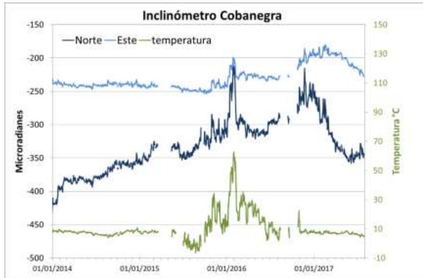
Figura 14. Componentes de inclinación Norte y Este ( \mu\text{rad} ) del inclinómetro electrónico Cobanegra, instalado en Galeras, para el periodo comprendido entre el 1 de enero de 2014 y el 31 de julio de 2017.
