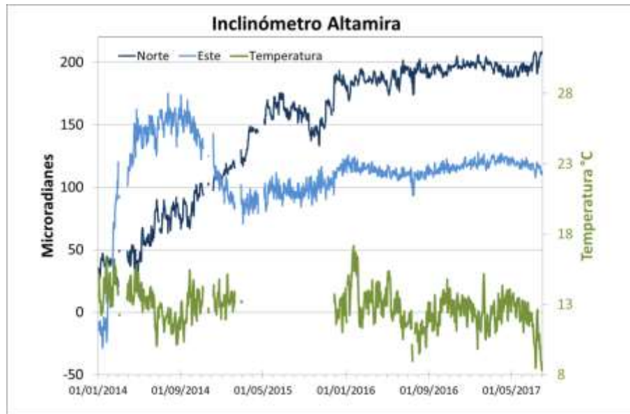
Figura 75. Componentes de inclinación Norte y Este, temperatura del inclinómetro electrónico Altamira, instalado en el límite entre los volcanes Doña Juana y Las Ánimas, para el periodo comprendido entre el enero de 2014 y julio de 2017.
